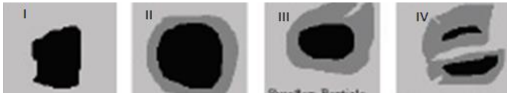
Figura 3. Partículas de caucho hinchado, (I, deshinchada), (II, partícula hinchada), (III, Parte inflamada, comenzará a despolimerizarse) y (IV, despolimerización de partículas) (Lo Presti et al 2012).
